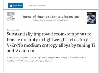
材料学院賈嶽飛博士在 Journal of Materials Science & Technology 上發表輕質難熔中熵合金的應用新思路和方向的最新研究成果。這項研究不僅解決了科學家們長期以來的困擾,還為工程應用開闢了新的可能性。具體來說,通過系統調節 Ti 和 V 的含量,研究人員揭示了一種內在的延展性機制。這種機制使得斷裂形式從晶間脆性斷裂向韌性斷裂轉變。此外,調控後的變形機制也從單一滑移模式演變為多重協同滑移模式,而合金的強度並未明顯降低。以(Ti1.5V)3ZrNb 為例,相比等摩爾比的 TiVZrNb 中熵合金,其延伸率提高了 360%,同時保持了約 800 MPa 的高屈服強度。這一成果顯示,合金構成元素的調控不僅通過減少有害相而淨化晶界,還調控了變形位錯構型。這些見解為輕質難熔中熵合金的應用提供了新的思路和方向。
